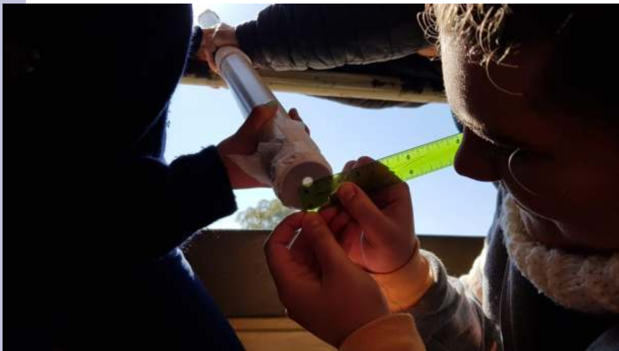
Figura 13. Medición del diámetro de la imagen del Sol en la cámara oscura
