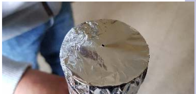
Figura 10. El orificio por donde entra la luz de Sol se realiza en el aluminio con un clavo fino
