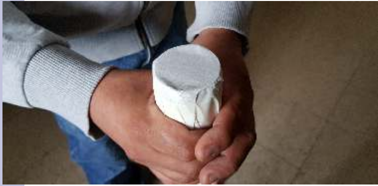
Figura 8. Instalación del papel de calcar en un extremo del tubo
