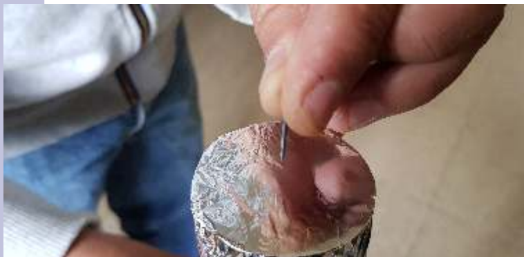
Figura 10. El orificio por donde entra la luz de Sol se realiza en el aluminio con un clavo fino
