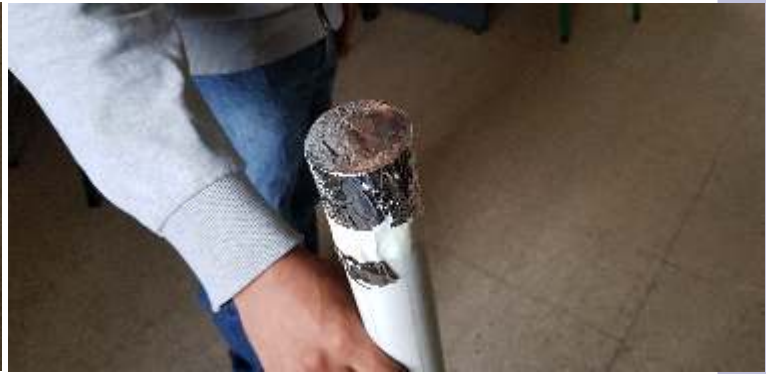
Figura 9. Instalación del papel de aluminio en el otro extremo del tubo
