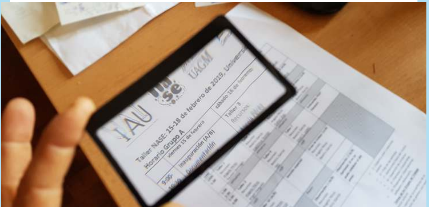
Figura 6. Lente de Fresnel como lupa: Objeto más cerca de la lente que el foco (real, derecho y de mayor tamaño)
