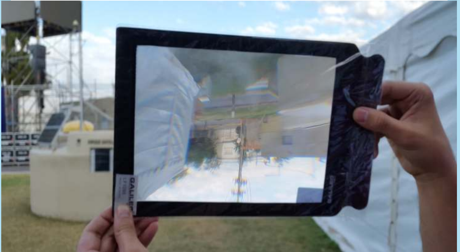
Figura 7 Lente de Fresnel com Lupa: Objeto más alla del foco de la lente (real, invertido, de menor tamaño)
